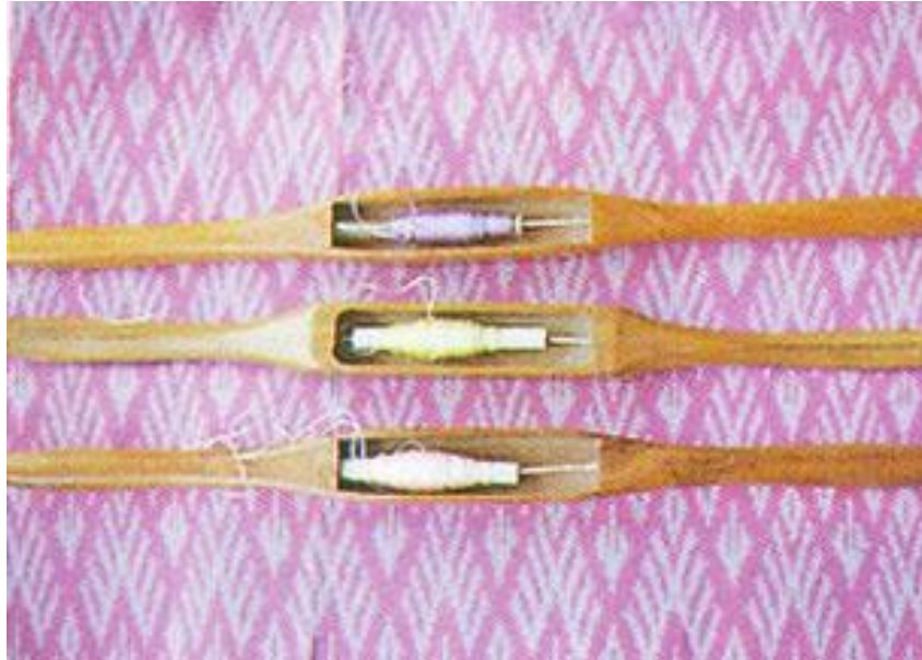
รูปภาพที่ 4 กระสวย เป็นเครื่องมือในการสอดด้ายเส้นพุ่ง
